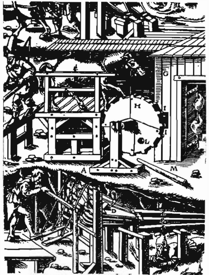
Máquina para introducir aire puro en las minas. Siglo XVI. G. Agrícola.
