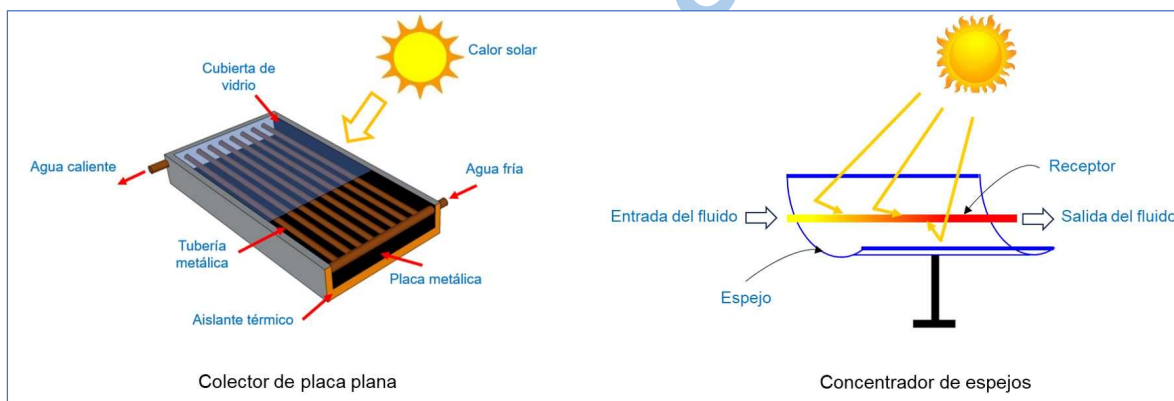
Figura 2. Componentes de un colector solar de placa plana (izquierda) y de un concentrador de espejos (derecha). Los colectores solares calientan un fluido caloportador (agua o refrigerante) mediante la irradiancia solar.
