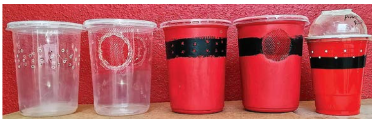
Figura 1. Diseños de trampas para monitoreo de D. suzukii evaluadas en cultivos de frutillas en Michoacán, México (Cruz-Esteban et al. , 2021a).
