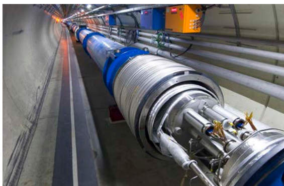
Figura 1. El túnel del LHC. Se observa el interior de un dipolo superconductor. Imagen tomada de https://cds.cern.ch/record/905940 . © CERN.
