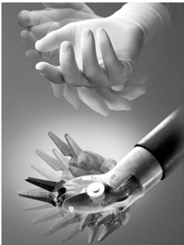
FIGURA 2. La tecnología Endowrist permite imitar los ángulos del movimiento de la mano humana mediante la flexión de los instrumentos en distintos ejes.
