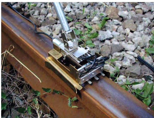
Figura 3. Detección de zonas de concentración de esfuerzos y grietas en riel de ferrocarril usando el método de memoria magnética. 1
