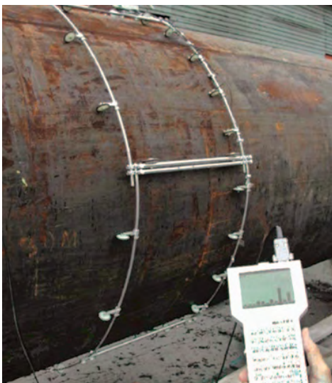
Figura 1. Detección de zonas de concentración de esfuerzos y grietas en una tubería de vapor usando el método de memoria magnética. 1
