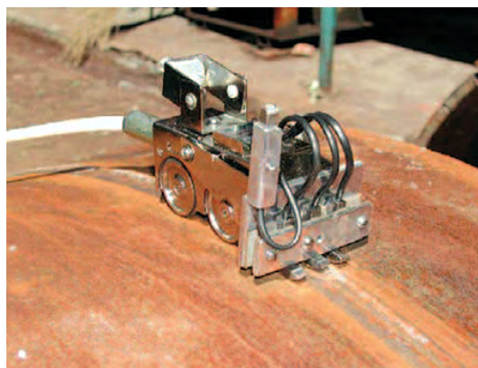
Figura 2. Inspección de defectos en una soldadura de tubería ferromagnética usando métodos magnéticos. 2
