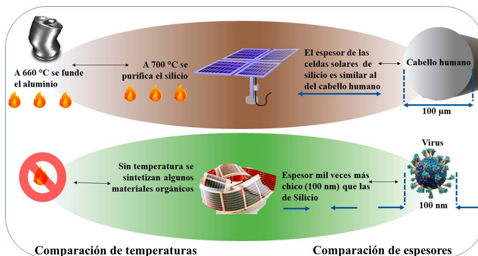
Figura 1. Comparación de temperaturas de elaboración y de espesores de celdas solares de silicio y orgánicas.
