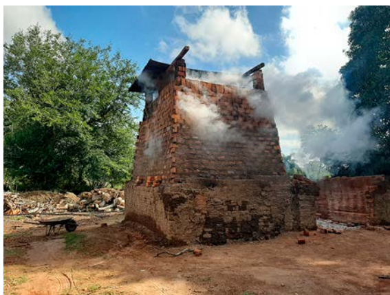
Figura 1. Horno artesanal usado para la producción de tabiques en la zona de Medellín de Bravo. Elaboración propia.
